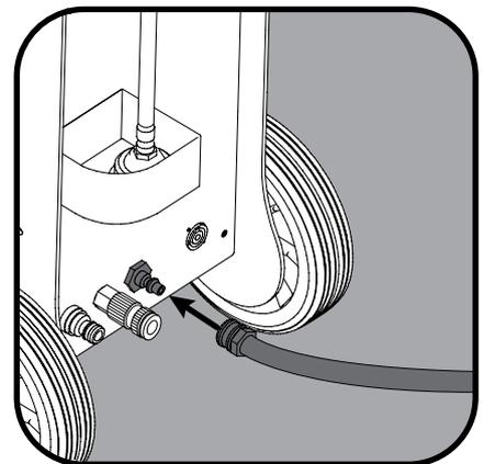
Collegare il tubo di alimentazione a bassa pressione alla presa di uscita dell'aria compressa del compressore. L'immagine mostra il collegamento con il generatore di aria compressa AR20.
