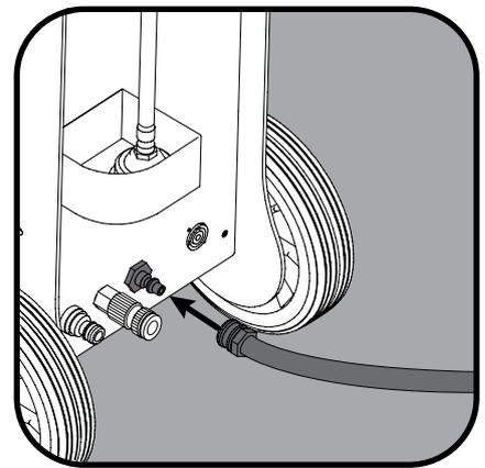
Réaliser le raccordement du tuyau à basse pression avec le raccordement de sortie d'air comprimé du compresseur que vous utiliserez. Sur cette image le raccordement est effectué avec le générateur en air comprimé AR20.
