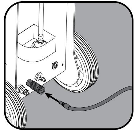
Raccorder le tuyau de liquides avec la lance à basse pression.
